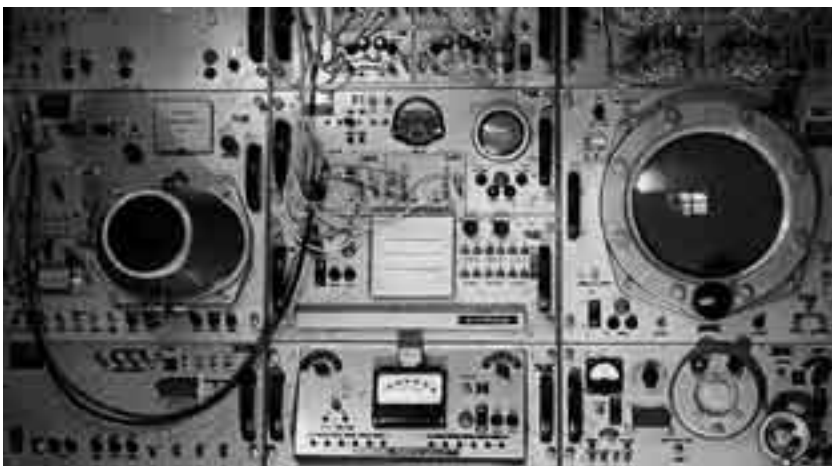
Abb. K706: Sowjetischer Peilarbeitsplatz „Post 3 M“ für den Kurzwellenbereich (System 1 RL 220 M).
